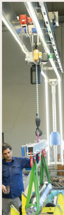
statt manuellen Antrieben wird die Arbeit erleichtert und fordert weniger körperliche Anstrengung vom Anwender. Beim Arbeiten mit dem Alu-Portalkran mit elektrisch verfahrbarer Laufkatze ist kein persönlicher Kraftaufwand notwendig. Ein weiterer Vorteil ist ihre **Präzision**. Die Last kann sanft und genau bewegt und exakt positioniert werden. Dies ist besonders wichtig, wenn es um empfindliche oder teure Materialien geht, die sorgfältig behandelt werden müssen.
